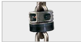
Prellgummi und Ketten- stopper aus Edelstahl am lastfreien Kettenende
