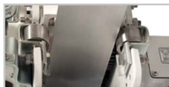
Seitliche Führungsrollen (MR2) aus Edelstahl
